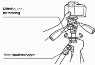
Halten Sie den Stativkopf mit einer Hand fest und lösen Sie den Mittelsäulen-Abschlusspfropfen sowie den Klemmring mit der anderen Hand. Heben oder senken Sie den Stativkopf auf die gewünschte Höhe und drehen Sie Klemmring und Pfropfen fest, während Sie den Stativkopf festhalten.
