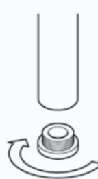
Drehen Sie den Verschlusspfropfen am unteren Ende der Mittelsäule in Pfeilrichtung.
